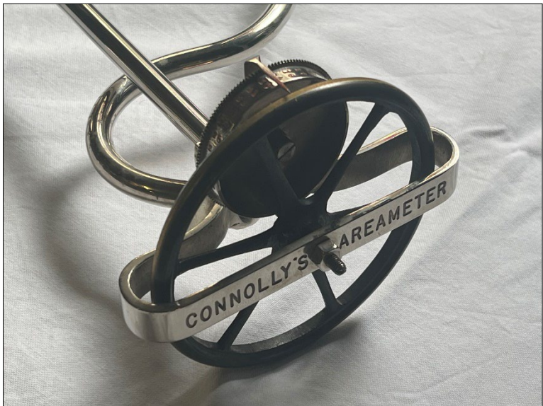
Details eines Apparates zur manuellen Messung der Flächen von Fellen und Häuten.
