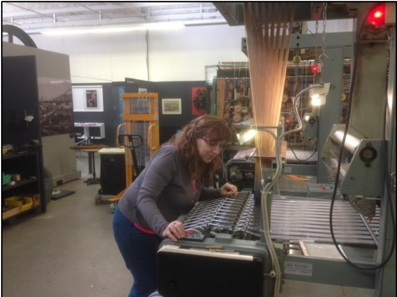
Langjährige Erfahrung, geschickte Hände und viel Knowhow: Frau Calvelo beim Fäden Einziehen an der Namenbandwebmaschine.
